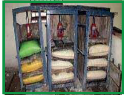
Photos 8,9 & 10: Egouttage et fermentation du manioc dans des étagères
